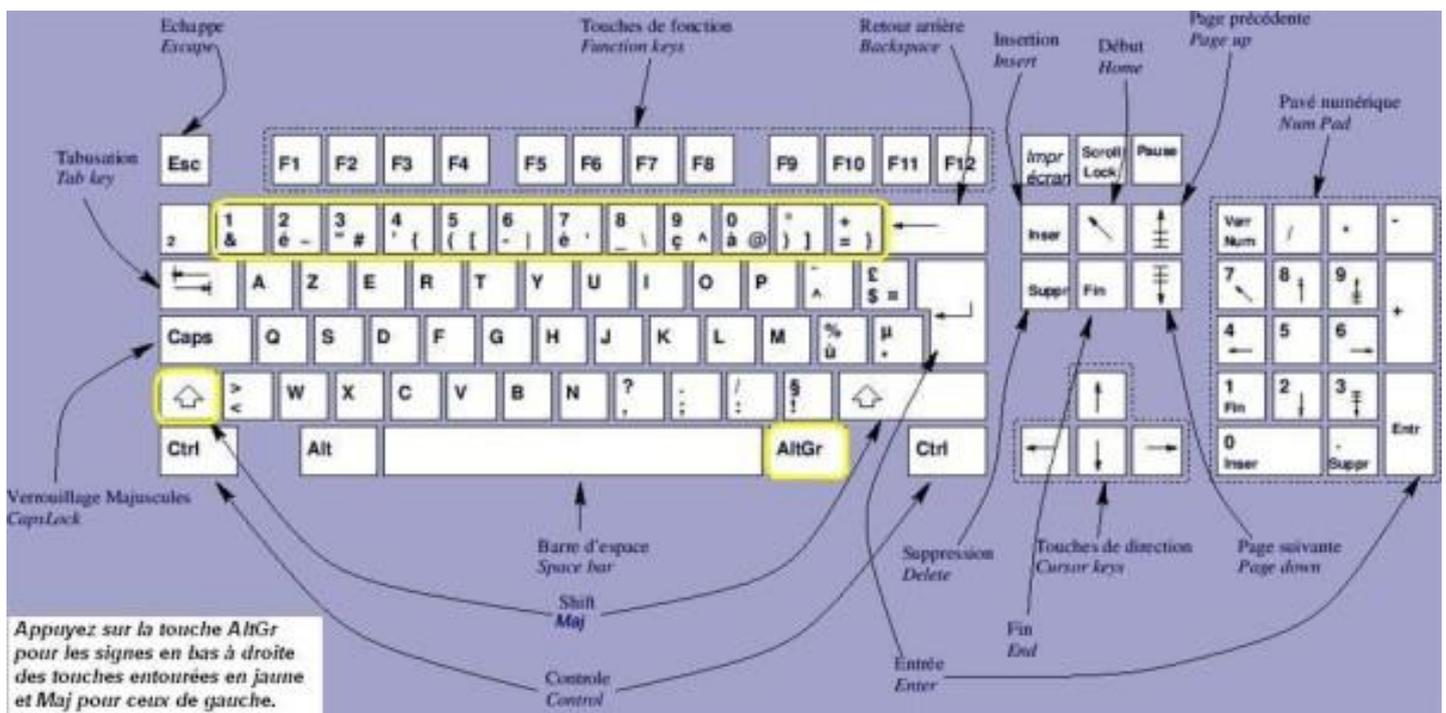
Figure 2 : vue détaillée du clavier PC
