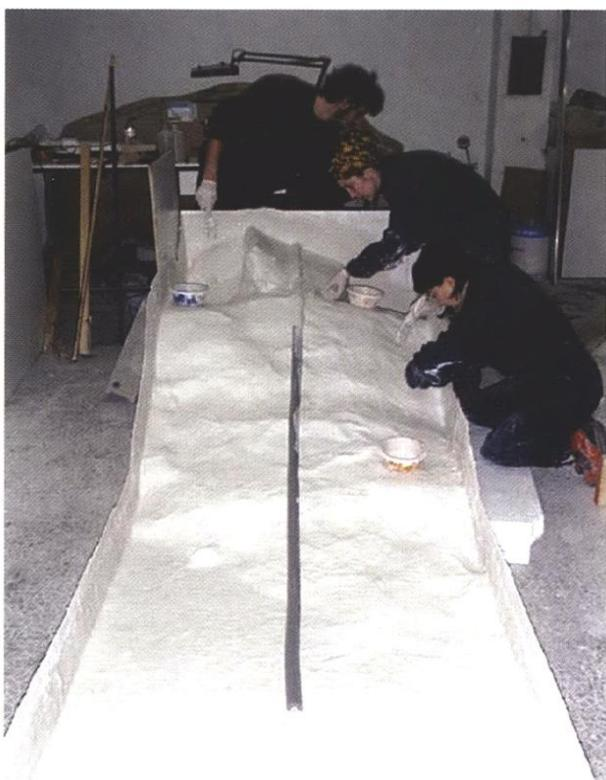
Figure 3 - Tirage du positif à partir du moule réalisé sur la paroi fraisée en mousse. Photo A. Dalis.
