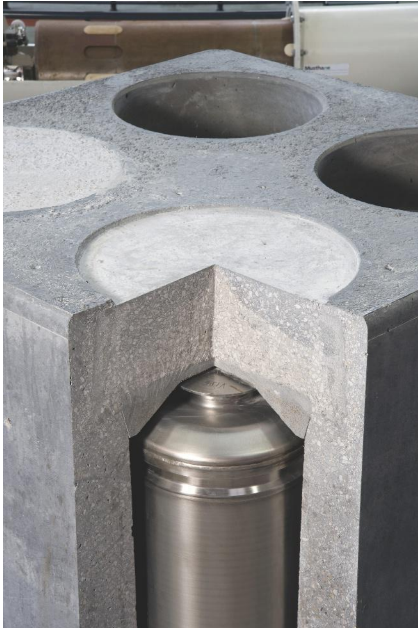
fig. 1 Démonstrateurs de conteneurs de stockage MA VL en béton de type B5 2. Photographie Philippe Demail © Andra.
