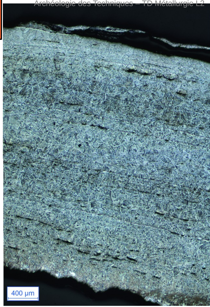
Expérimentation : barre forgée en bronze Méandre Archéométreurgie (analyses IRAMAT)
