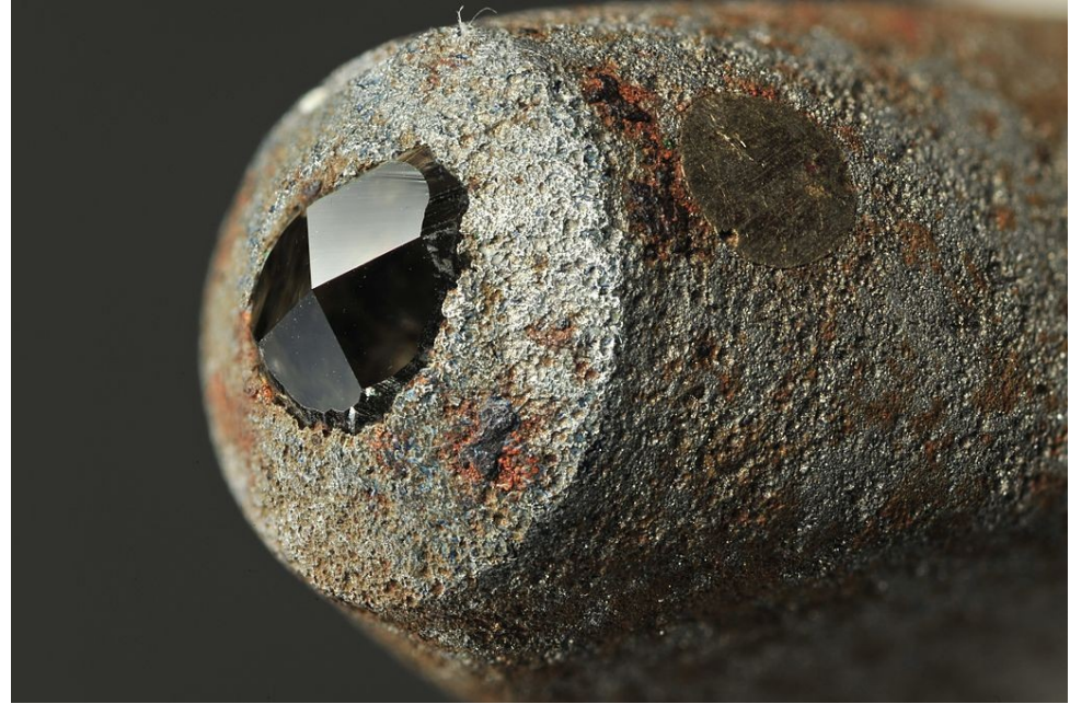
Schéma du principe de la dureté selon l'Essai Vickers Pénétrateur en diamant
