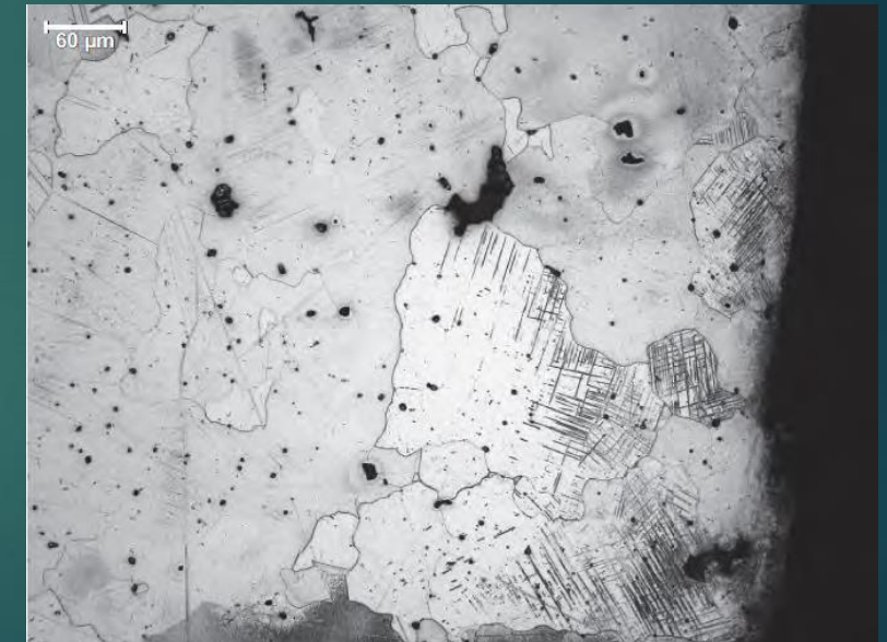
Grains dont les macles témoignent d'une déformation à froid (tranche)
