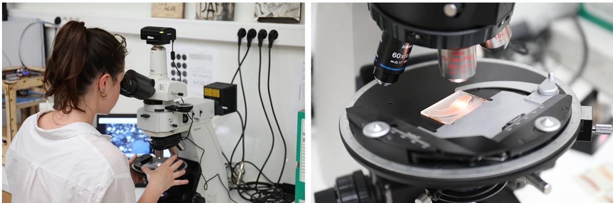
Fig. 7 : Microscope pétrographique associé à une caméra, reliée à un ordinateur pour la photographie des lames minces.
