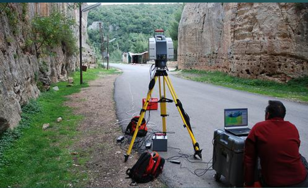
Numérisation au scanner laser sur trépied en archéologie du bâti
