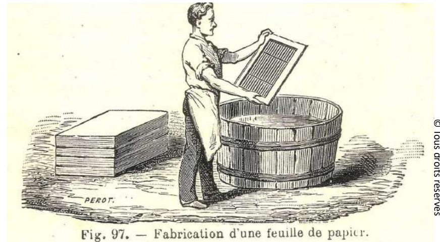
Fabrication du papier, Leçons élémentaires de chimie , (B.Bussard, H.Dubois) 1906, fig. 97
